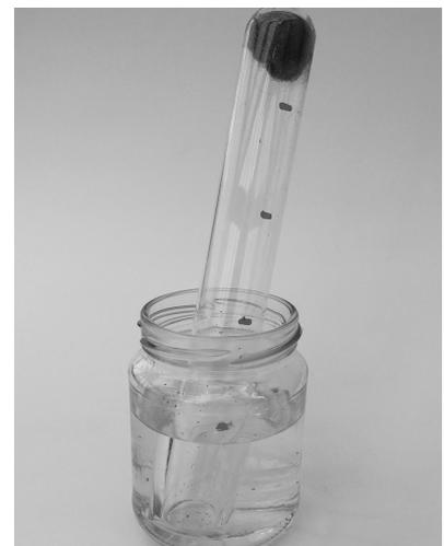
6. Der Sauerstoffgehalt der Luft kann an den Markierungen abgelesen werden. Der Versuch kann ev. mit der gleichen Eisenwolle wiederholt werden.
